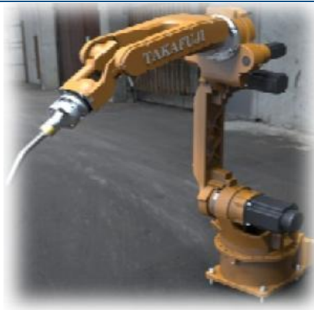
图 24:利和兴 LR1400 型工业焊接机器人
