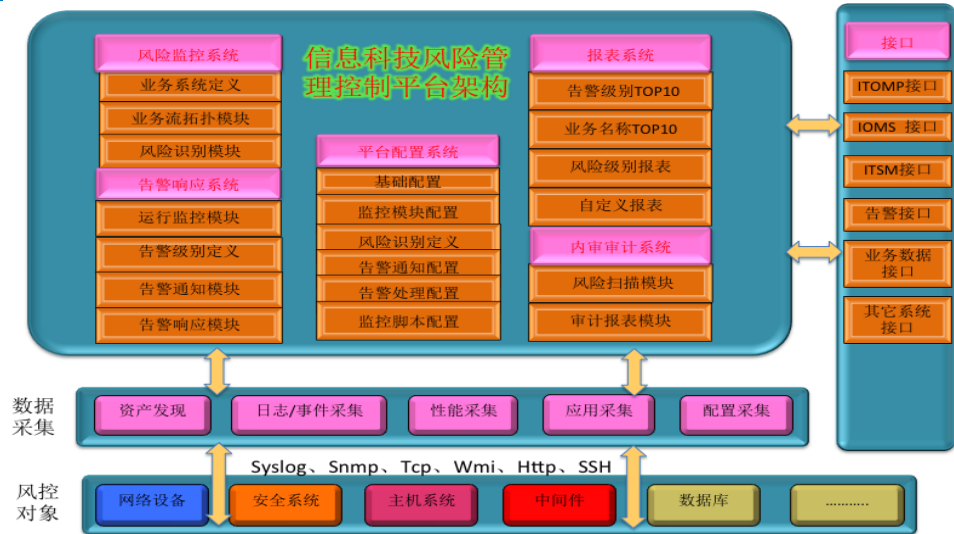
图 14：信息科技风险管理控制平台架构图
