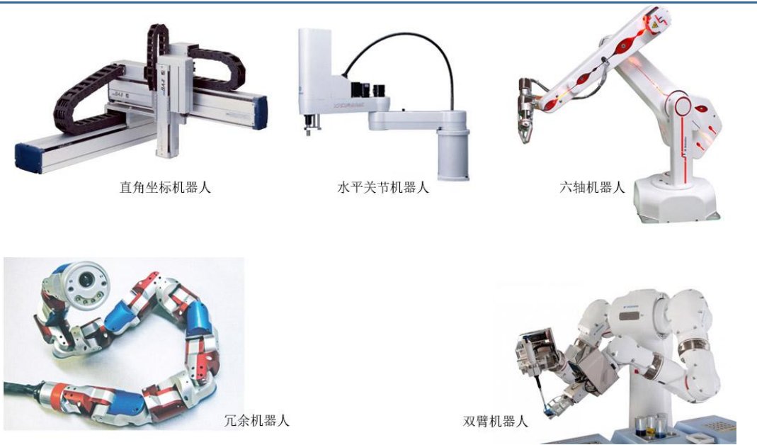
图表 9 工业机器人按照运动方式分类
